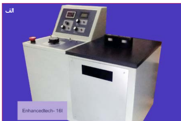
▲ تصاویر دستگاه الف) Enhancedtech-16I مولد پلاسمای سرد اتمسفری برای تحقیقات صنایع غذایی و ب) Plasmatech-15A
