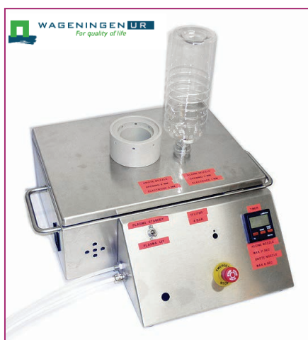
شرکت Wageningen UR - FBR از پلاسمای RF برای استریل کردن داخل ظروف PET بهره گرفته است.
