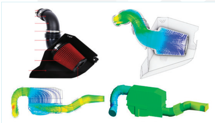
شکل ۲- کاهش افت فشار و افزایش نرخ گردش هوا را می‌توان با طراحی مناسب شکل فیلتر (شکل بالا) و جعبه نگهدارنده فیلتر (شکل پایین) افزایش داد [۵]
