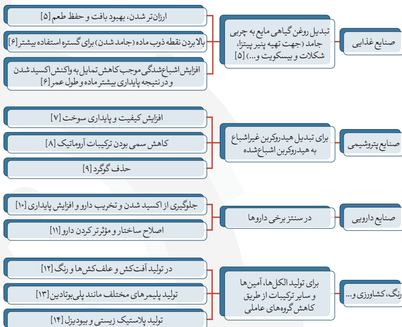
شکل ۱- کاربرد فرایند هیدروژناسیون در صنایع مختلف [۱]
