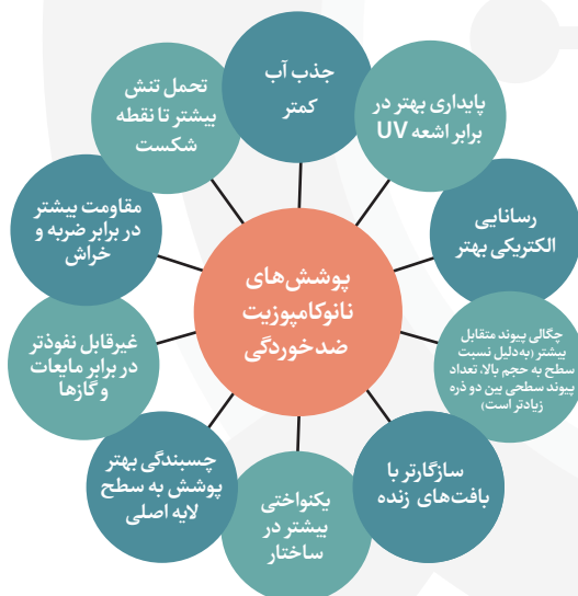
شکل ۱- مزیت‌های پوشش‌های نانوکامپوزیت ضد خوردگی [۵]
