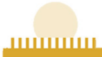
شکل ۴- تأثیر زبری سطح در زاویه تماس قطره با سطح [۱۲]
