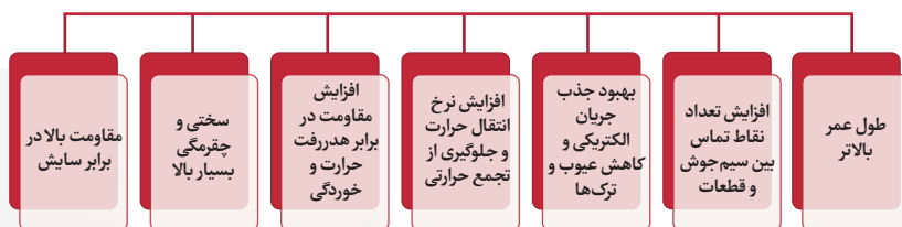
شکل ۳- مزایای استفاده از نانوذرات در سیم جوش های توپودری
