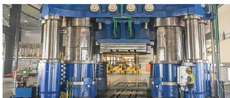
شکل ۱- الف) پرس هیدرولیک ۶ هزار تن ساخت شرکت ویرمتال ۱
