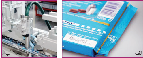
▲ الف) استفاده از پلاسمای سرد در افزایش چسبندگی چسب بر کارتن در شرکت BOBST ب) استفاده از پلاسمای سرد در چسباندن روکش‌ها و جعبه‌های دارای روکش و پلاستیکی
