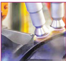
▲ پردازش پنل Peguform توسط پلاسمای GmbH
