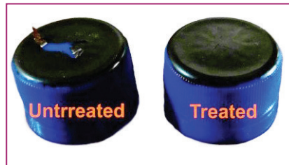
▶ چسبندگی پوشش رنگ بر روی درب بطری در دو حالت بدون پردازش (سمت چپ) و پردازش شده با پلاسمای سرد (سمت راست)
