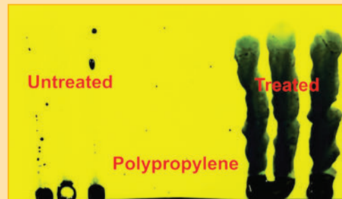
▲ آب‌دوستی و رنگ‌پذیری فیلم پلی پروپیلن در دو حالت بدون پردازش (سمت چپ) و پردازش شده با پلاسمای سرد (سمت راست). قطرات جوهر قرار داده شده بر بالای فیلم پلی پروپیلن پردازش نشده بدون تر کردن سطح و رنگی نمودن آن به پایین غلطیده‌اند در حالی که قطرات جوهر بر روی بخش پردازش شده در مسیر خود کاملاً سطح را تر و رنگی کرده‌اند.
