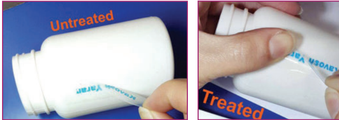
▲ چسبندگی بسیار متفاوت پوشش رنگ بر روی قوطی‌های پلاستیکی بدون اعمال پلاسما (سمت چپ) و پردازش شده با پلاسمای سرد (سمت راست)
