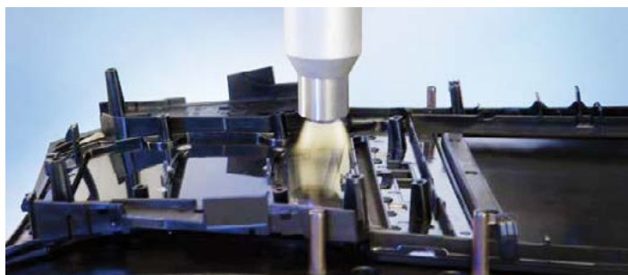
بهبود چسبندگی بین PET و فویل بدون ایجاد حباب با پلاسما در پنتل Ford Lincoln MKZ.
