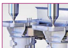
فرآیند آب بندی شیار موتور توسط پلاسما
