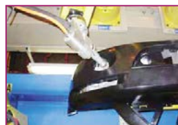
▲ رنگ کردن سپر از جنس ترموپلاستیک TPO توسط دستگاه نمونه در شرکت Ford ۷
