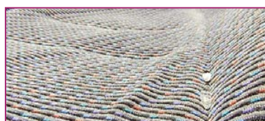
▲ روکش صندلی آب‌گریز تولید شده در شرکت Hai Yent seat cover توسط فناوری پلاسما ۱۰
