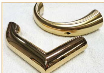
▲ نمونه پوشش های PVD دستگیره ها در رنگ های سیاه خاکستری، طلایی و مسی
