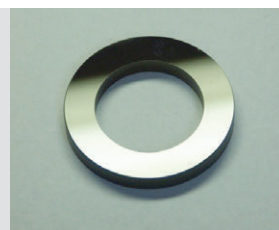
▲ نمونه‌ای از پوشش UNDC پس از پولیش.
