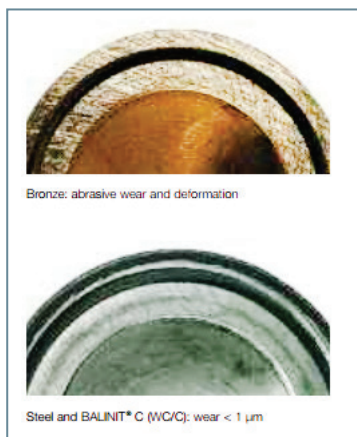
▲ سایش و دفرمه شدن قطعه برنزی در کنار سایش کمتر از یک میکرون برای قطعه با پوشش DLC
