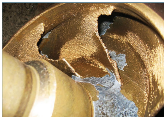
▲ تخریب پروانه پمپ در اثر پدیده کاویتاسیون
