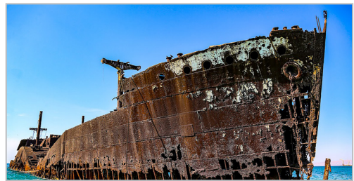
شکل ۴- خوردگی در کشتی‌های فلزی
