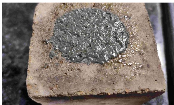
شکل ۱- ZnS:Cu اعمال شده بر روی سطح نمونه بتنی [۴]
