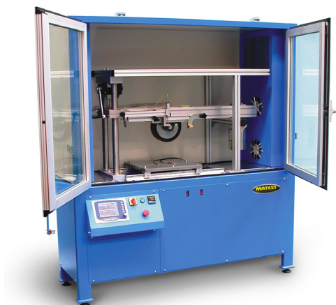
شکل ۶- دستگاه ویل تراک برای ارزیابی شیارشدگی نمونه آسفالت
