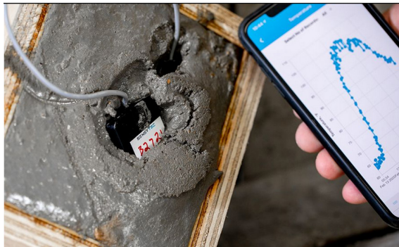
شکل ۱- نظارت هوشمند بر سلامت سازه بتنی
