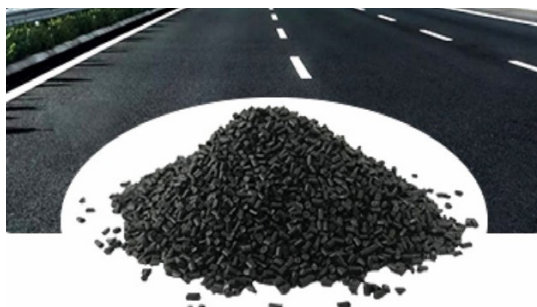
شکل ۳- افزودنی با مقیاس میلیمتری برای خواص ضدشیارشدگی آسفالت
