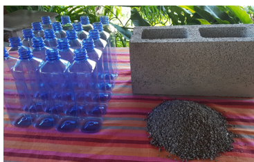
شکل ۳- بلوک سیمانی حاوی پلیمرهای بازیافتی
