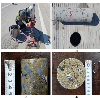
شکل ۱- استفاده آزمایشی از بتن دارای گوگرد در جاده و آزمون‌های مکانیکی انجام شده
