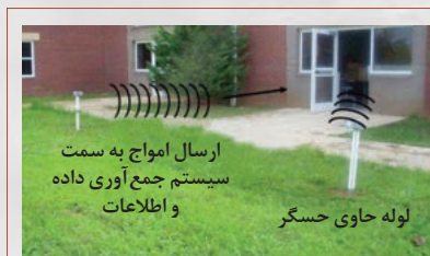
» شکل ۷. تست مزرعه‌ای نانوحسگر و ارسال اطلاعات توسط آن
