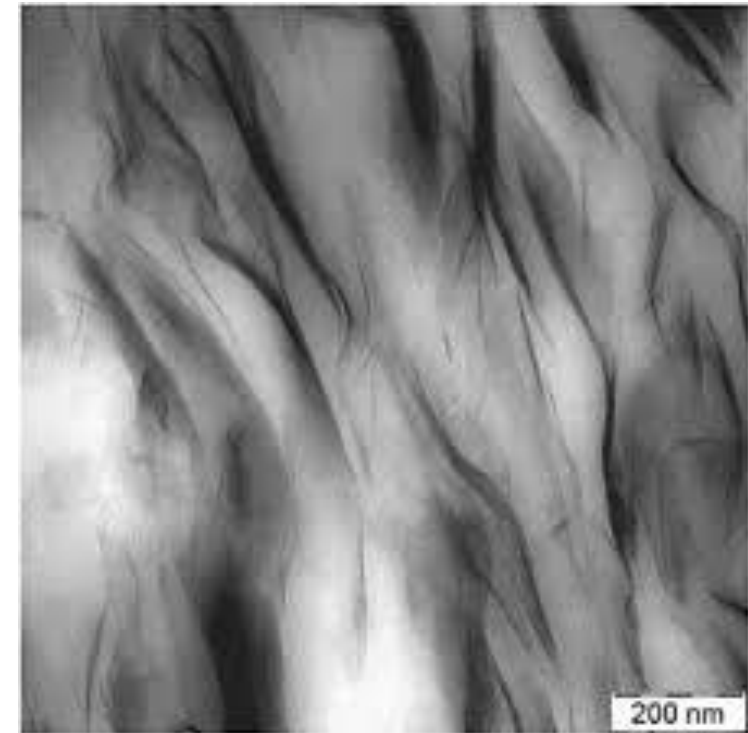
تصویر TEM از نانولایه های رس در بستر پلیمری
