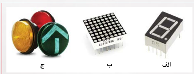
شکل ۳. الف) یک نمایشگر هفت‌قسمتی ب) یک نمایشگر ماتریسی ج) چراغ راهنمایی با استفاده از دیود نورافشان
