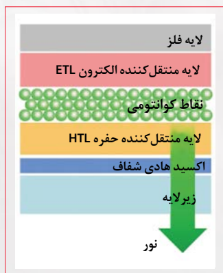
➤ شکل ۷. ساختار یک QDLED با تحریک الکتریکی [۱۳]
