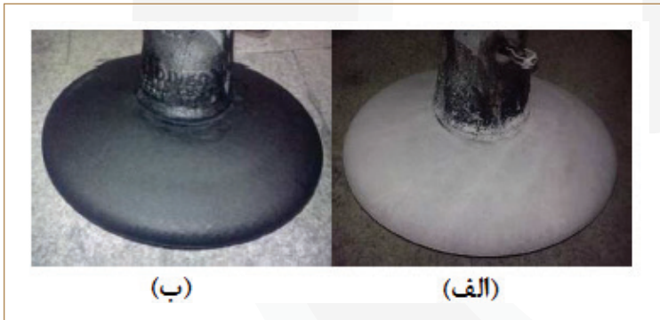
شکل ۲۵- مقره شیشه‌ای با الف- لایه ابرآب‌گریز بر روی لایه نیمه رسانا (پوشش ترکیبی) ب- لایه نیمه رسانا به تنهایی
