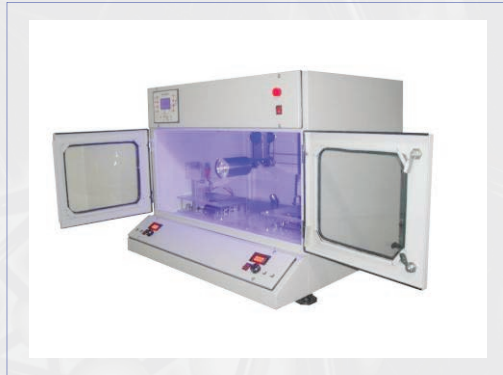
» شکل ۱۲. دستگاه الکترورسی تمام خودکار ساخته شده در شرکت نانوآرما [۱۸]
