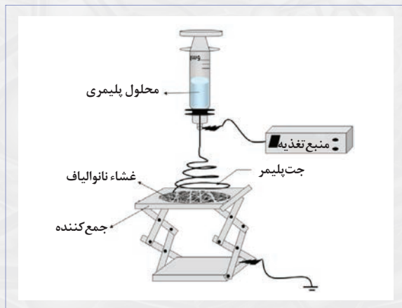
» شکل ۴. شمای کلی از یک دستگاه الکتروریسی استاندارد [۴]
