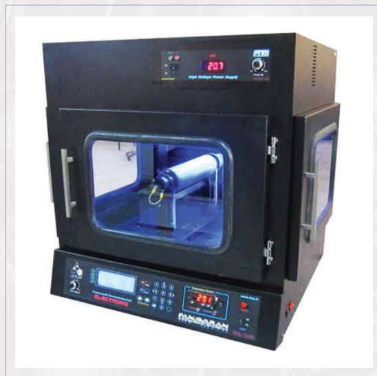
» شکل ۱۳. دستگاه الکترورسی برای تولید نانوالیاف که توسط شرکت آدیکو تجاری‌سازی شده است [۱۹]
