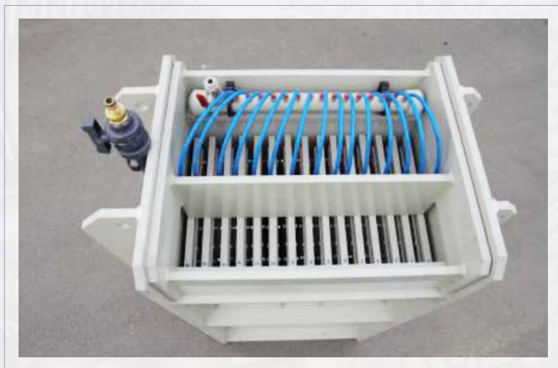
شکل ۶. سیستم پایلوت مورد استفاده برای انجام اولترافیلتراسیون بوسیله غشاء نانوالیاف پلی‌اورتان [۶]
