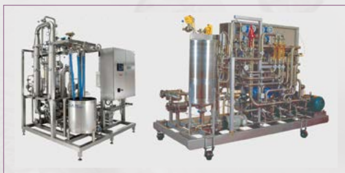
» شکل ۱۲. دو طرح پایلوت شرکت GEA برای نانوفیلتراسیون با غشاهای سرامیکی؛ سمت چپ: طرح پایلوت مدل R و سمت راست: طرح پایلوت مدل C [۱۶]
