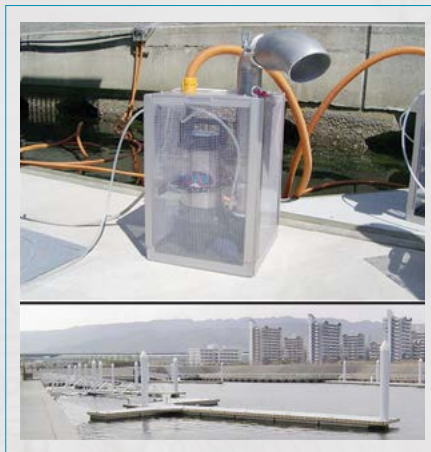
➤ شکل ۱۱. دستگاه تولیدکننده میکرو حباب و اجرای آن در بندر Shio-Ashiya واقع در خلیج Osaka ژاپن
