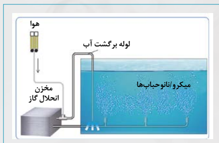
شکل ۷. روش رفع فشار جهت تولید میکرو/نانوحباب [۳]
