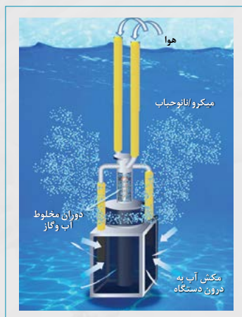
» شکل ۸. روش دوران آب-گاز (روش جریان مایع مارپیچی) جهت تولید میکرو/ نانوحباب [۳]
