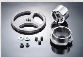
روشی نوین برای ساخت و تولید قطعات فلزی و سرامیکی است که اساس آن بر فشردن پودر مواد به شکل موردنظر و تفجوشی در درجه حرارتی زیر نقطه ذوب می‌باشد. متالورژی پودر فرآیند قالب‌گیری قطعات (غلب فلزی) از پودر فلز توسط اعمال فشارهای بالا است. پس از عمل فشردن و تراکم پودرهای عمل تفجوشی در دمای بالا در اتمسفر کنترل شده، انجام پذیرفته
