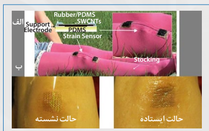
شکل ۷. الف) حسگر حرکت سنج خمشی ساخته شده از نانولوله‌های کربنی که حرکات مفاصل را اندازه می‌گیرد [۳]. ب) نانو حسگر حرکت سنج که به صورت برجسته بر روی زانو قرار گرفته است [۶]
