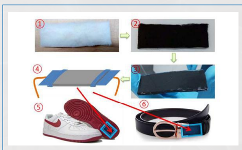
» شکل ۱۲. نانوحسگر فشاری کربنی که در کف کفش و یا بخش داخلی کمر بند قرار می گیرد [۱۳]
