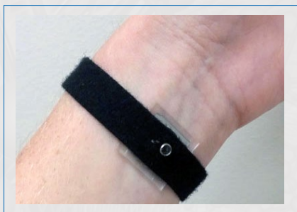
» شکل ۱۳. یک حسگر نوار عضله بی سیم ساخته شده از نانو میله های نقره [۱۴]
