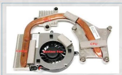
شکل ۱۱. لوله حرارتی استفاده شده در تجهیزات رایانه
