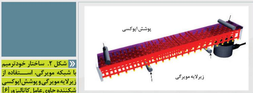
شکل ۲. ساختار خود ترمیم با شبکه مویرگی. استفاده از زیر لایه مویرگی و پوشش اپوکسی شکننده حاوی عامل کاتالیزور [۶]
