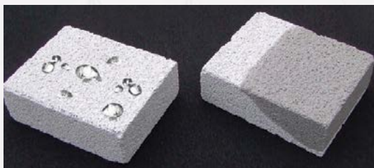
» شکل ۱۱. مقایسه میزان جذب آب در بتن با روکش نانو و بدون روکش نانو.
