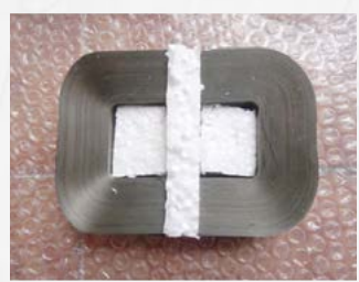
شکل ۷. یک هسته نانو کریستالین از تجمیع کردن نوارهای آمورف نانو کریستالین
