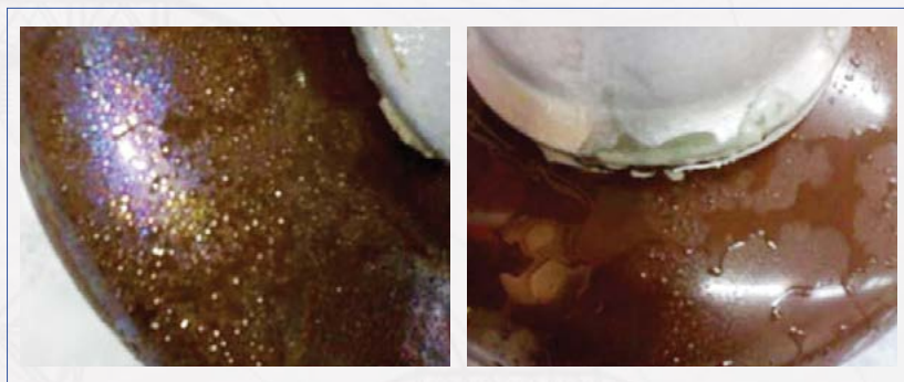
شکل ۱۴. سمت راست، مقره قبل از پوشش‌دهی و خیس شدن سطح آن با آب و در قسمت سمت چپ، نحوه قرارگیری قطره آب بر روی مقره بعد از اعمال پوشش.
