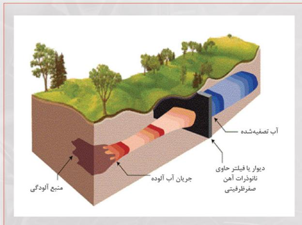
با استفاده از فیلترهای حاوی نانوذرات و قرار دادن آن در مسیر عبور آب می‌توان انواع آلاینده‌ها را هم‌زمان جذب و یا حذف کرد. بنابراین دور از انتظار نیست که بتوان از فیلترهای محتوى این نانوذرات در دستگاه‌های تصفیه آب نیز بهره‌برد (شکل ۶).
