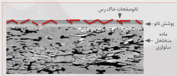
شکل ۵. پوشش نانوفیبری دارای نانوصفحات خاک رس بر روی کاغذ [۳]
