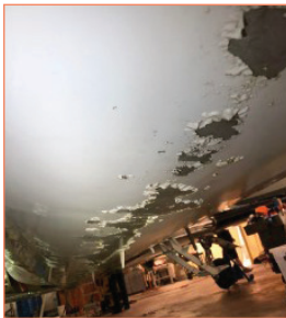
شکل ۳- تأثیر خوردگی اسکایدربول بر بدنه هواپیما
