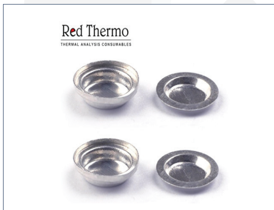
شکل ۱- نمونه‌ای از بوته‌های معمولی که برای آنالیز DSC استفاده می‌شود. [۱]
