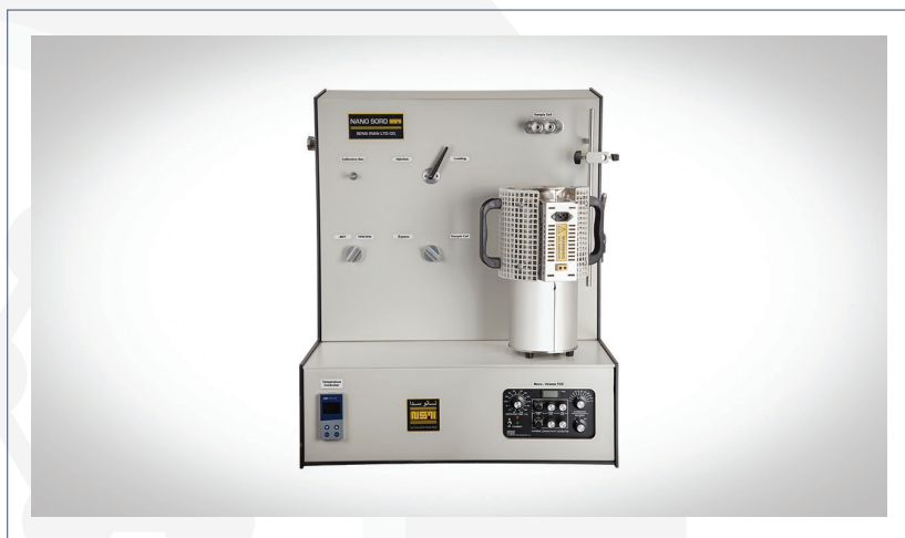
▲ شکل ۵- دستگاه اندازه گیری سطح ویژه و آنالیز جذب و دفع شیمیایی
