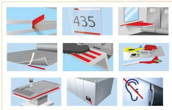
شکل ۵- نمونه‌ای از کاربردهای چسب‌ها در قسمت‌های مختلف هواپیما. از راست به چپ: محافظت سطوح حساس، نصب قطعات کوچک، پوشش دهی، محافظت از کابل‌ها، سطوح ضدلغزش، کف، لرزش زدایی (صدازدایی)، پرچسب‌های شناسایی، اتصال صفحات لانه زنبوری [۳۱].
