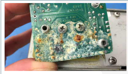
شکل ۲- مدار الکترونیکی آسیب دیده در اثر خوردگی
