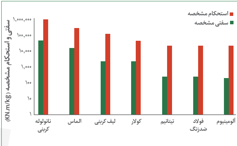
شکل ۲- مقایسه سختی و سختی نانولوله کربنی و مواد دیگر
