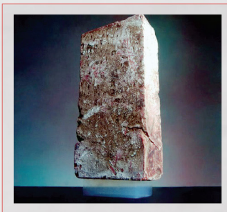
▲ یک قطعه آجر ۲/۵ کیلوگرمی روی تکه‌ای ۲ گرمی از آئروژل گذاشته شده است.
