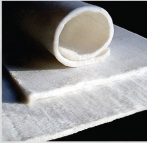
▲ آئروژل پتویی (کامپوزیتی است از آئروژل سیلیکا و الیاف تقویت کننده)
