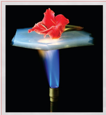
▲ گلی که بر روی تکه‌ای از آئروژل حرارت دیده معلق شده: آئروژل عایق حرارتی بسیار خوبی است، چنان‌که گل از حرارت شعله هیچ آسیبی ندیده است.
