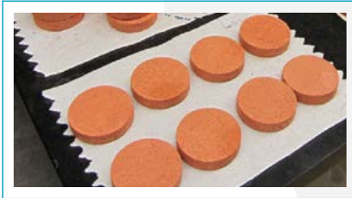
شکل ۶. فیلترهای سرامیکی متخلخل با خواص آنتی‌باکتریال محصول شرکت MadiDrop
