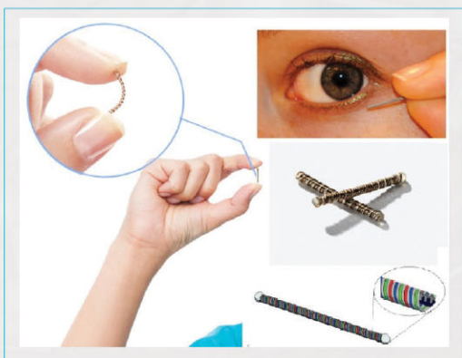
شکل ۵. حسگر تشخیصی قند خون بی‌سیم از طریق تماس با اشک
