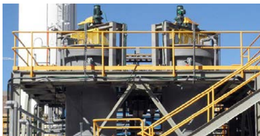
◀ شکل ۵. شمایی از سامانه روزینی شرکت BQE Water جهت حذف سولفات از پساب صنایع معدنی [۷].
