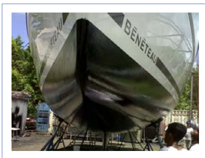
» شکل ۸. نمونه ای از کاربرد نانوپوشش آنتی فولینگ Biocyl در بدنه قایق
