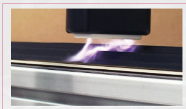
» شکل ۱۲. پردازش سطح EPDM توسط پلاسمای قوسی خزنده [۱۱]
