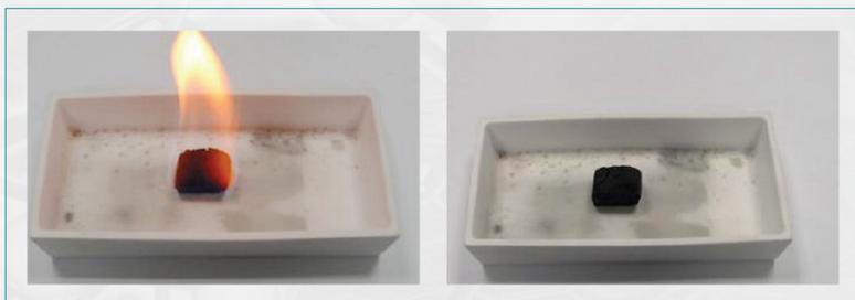
شکل ۸. چپ: آتروژل در حال سوختن، راست: آتروژل بازیابی شده پس از استخراج مواد نفتی جذب‌شده
