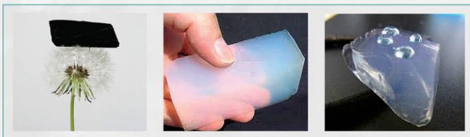
شکل ۲. شکل راست: آب‌گریزی آتروژل سیلیکاتی، شکل وسط: آتروژل سیلیکاتی با ساختار شفاف، شکل چپ: آتروژل کربنی روی گل قاصدک قرار داده شده و وزن پایین آن هیچ تغییری بر ساختار ظریف قاصدک ایجاد نکرده است.
