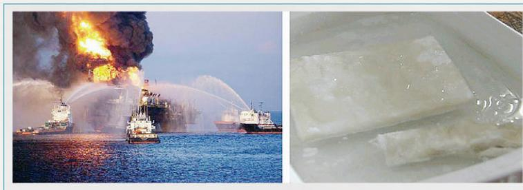
■ محصول با نام تجاری RECAM (مواد کربنی واکنش پذیر) توسط شرکت Ing. Aglietto معرفی شده که برای جذب لکه‌های نفتی کوچک و متوسط پیشنهاد شده است. این جاذب سازگار با محیط زیست و غیر سمی است. همچنین جزو مواد فرومغناطیس محسوب شده و می‌تواند با کمک میدان مغناطیسی جمع‌آوری شود. RECAM می‌تواند تا ۹۰ برابر وزن خود نفت را جذب نماید.
