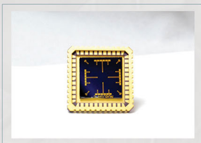
» شکل ۱. نمونه‌ای از یک نانوحسگر توسعه یافته برای تهدیدات نظامی با استفاده از نانولوله‌های کربنی ۲۵ و برنده جایزه ثبت اختراع ناسا [۱].
