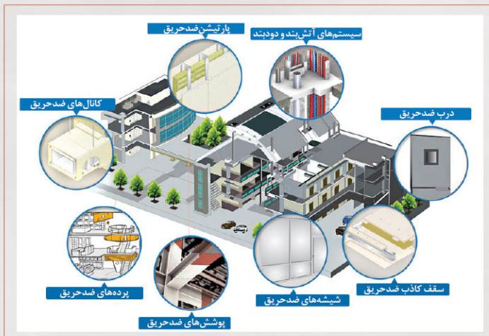
شکل ۲. شماتیک از ساختمان مقاوم در برابر حریق [۳]
