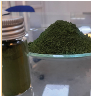
شکل ۱- نانوذرات اکسید کروم سبز سنتز شده در شرکت دُرِنیکا سبز پژوه از پساب آبکاری کروم
