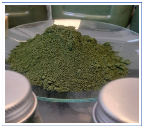
شکل ۴- نانوذرات اکسید کروم سبز سنتز شده از پساب آبرکاری کروم
